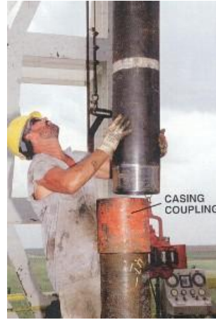
شکل ۸-۴. کاپلینگ کردن لوله های جدار(راست) و کاپلینگ(چپ)
